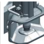
Önműködő pótkocsi vonófej hordós csappal Ø 38 mm
