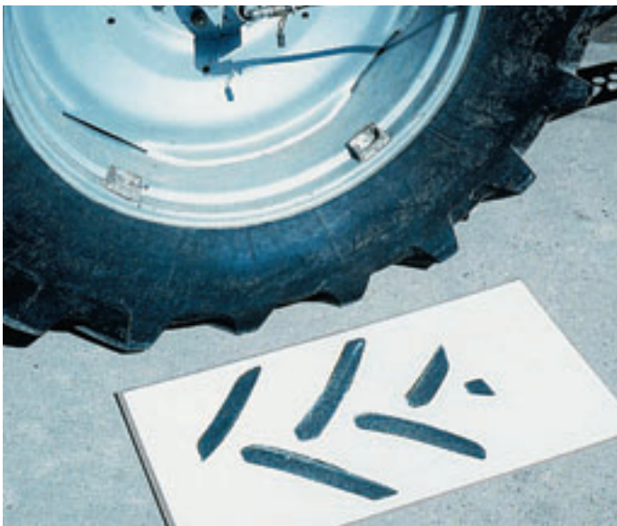
Felfekvő felület változása az abroncsnyomás csökkentésének hatására
