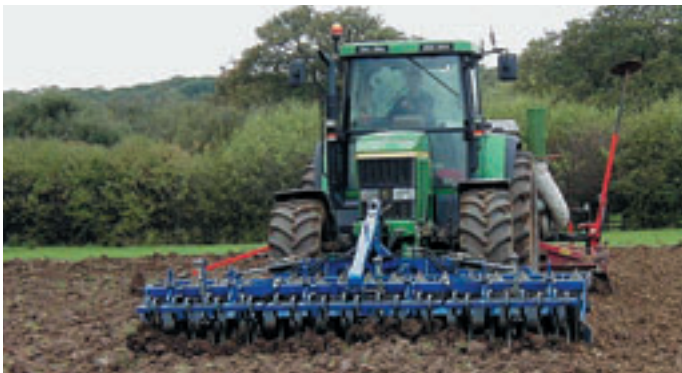
Szántáselmunkálóval kombinált vetőgép elrendezés
